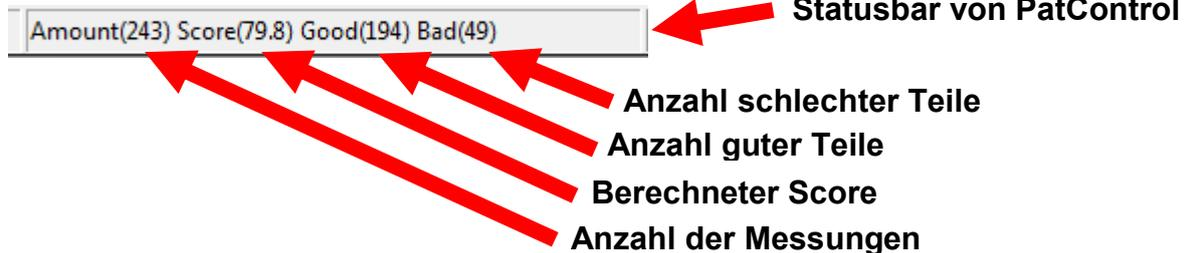
Der Parameter **state** ist normal immer Null, wenn der Operator im Menü von **PatControl** den **Menüpunkt** Camera/ResetCounter auslöst werden alle Zähler zurückgesetzt ausgenommen ist der **Logbuch-Zähler** der unten beschrieben wird. Der **Kamera-Trigger** wird Hardware und Softwareseitig ebenso zurückgestellt.
