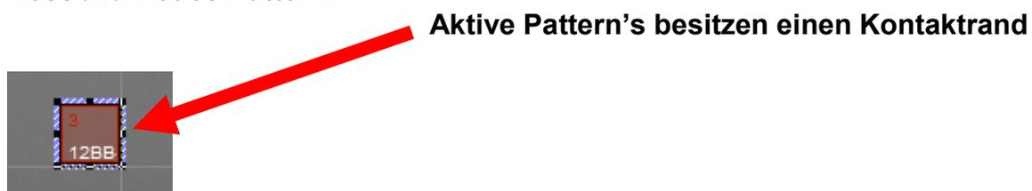
Das neue **Pattern** wird als kleines Rechteck dargestellt das nun mit der Maus in Position und Größe dem gewünschten Messbereich angepasst wird. Dazu werden mit der Maus die Standard **-Kontaktpunkte** die das Pattern umranden bewegt, Bzw. insgesamt verschoben, wenn der Mauscursor durch anklicken des Bereiches zu einem 4 Richtungszeiger wird.
